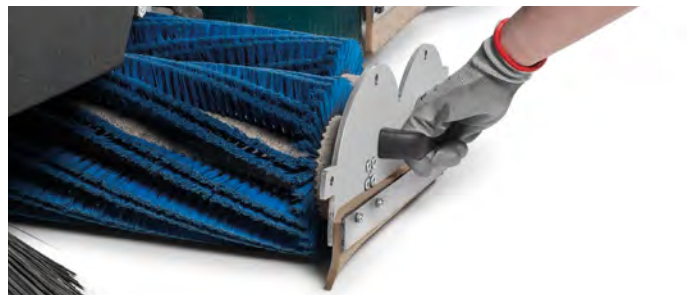
Les brosses et le système d'accouplement ont été conçus pour faciliter grandement l'opération de changement des rouleaux.
