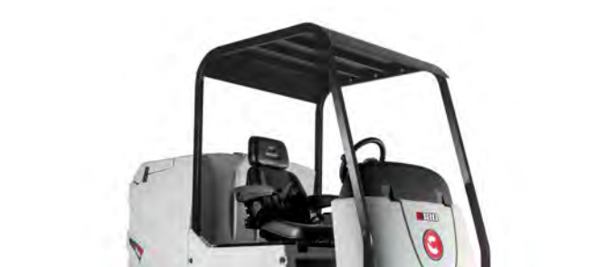
Possibilité d'installer le toit de protection pour protéger l'opérateur.
