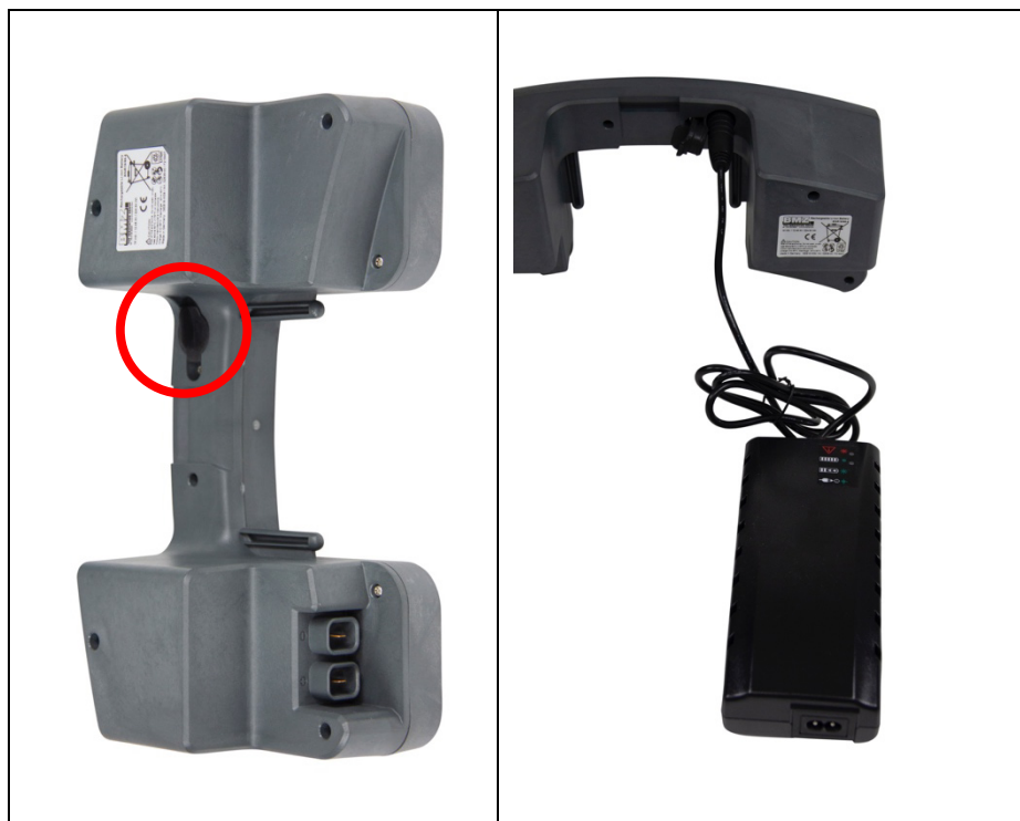
Figure 13 : Prise de charge sur la batterie
