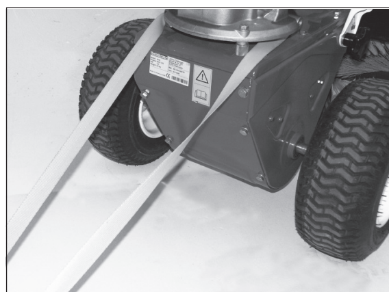
4) Utilisez le moteur comme point de fixation. Employez toujours les deux points de fixation. Pliez les guidons expédie entièrement.
