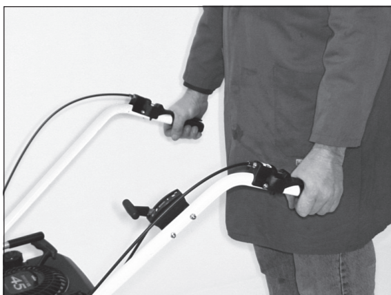
3) En actionnant l'embrayage de l'entraînement moteur, vous mettez la balayeuse en mouvement.
