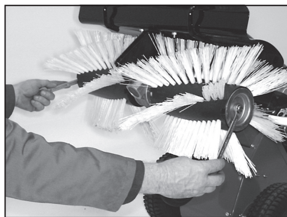
10) Serrer les écrous avec une clé mixte. Bloquer avec une autre clé mixte.
