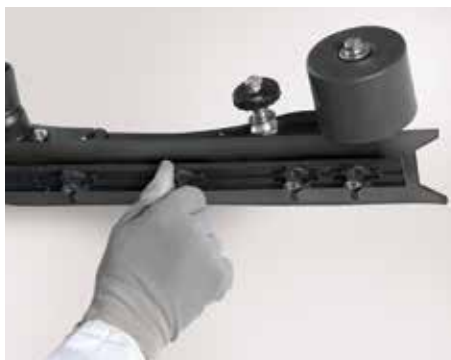
Eenvoudig, zonder gereedschap verwisselbare rubbers van de exclusieve Comac-wisser (Patent Pending)
