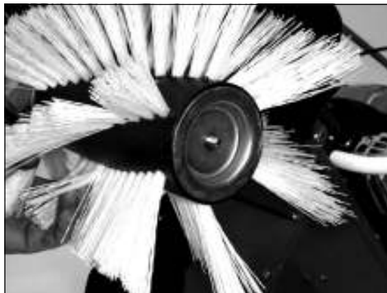
8) Nadat de beide borstels opgestoken zijn, de kap en onderlegschild op de as schuiven.
