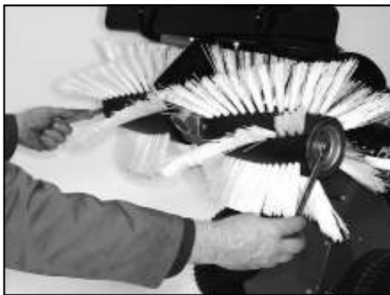
10) Moeren met een ring-gaffelsleutel stevig aandraaien. Hierbij met nog een ring-gaffelsleutel borgen.
