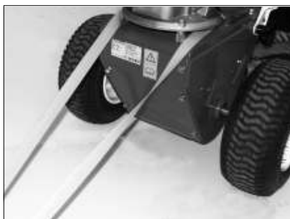
4) Geleiding van de spanriem achteraan. Gebruik altijd beide bevestigende punten. De duwboom wordt helemaal naar voren geklapt.
