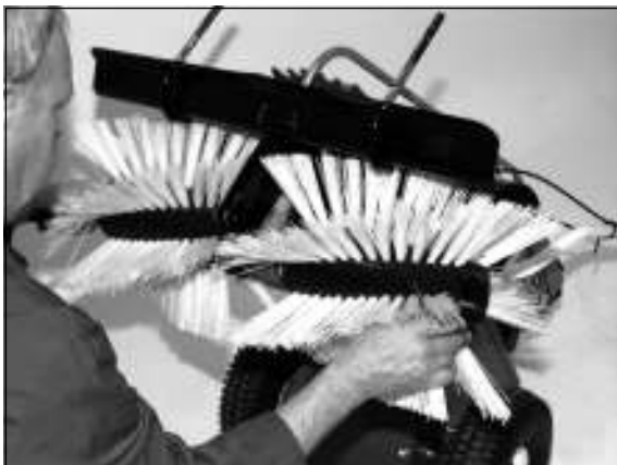
7) Schuif de linker veegborstel op de as. Neem hierbij het vorige montagevoorschrift in acht.
