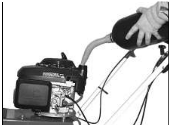
2) Houd de jerrycan zoals op de afbeelding. Vul slechts een kleine hoeveelheid en controleer de vulhoogte.
